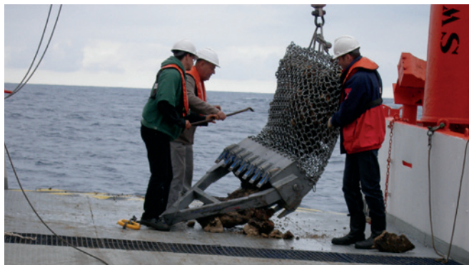
Chegada ao deck de uma draga com amostras de rocha EMEPC/Açores/G3/2007
