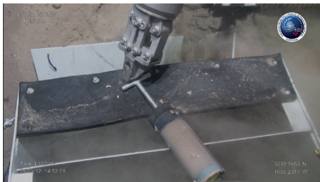
Amostragem de sedimentos com push corer a partir do Luso EMEPC/Açores/Luso2012
