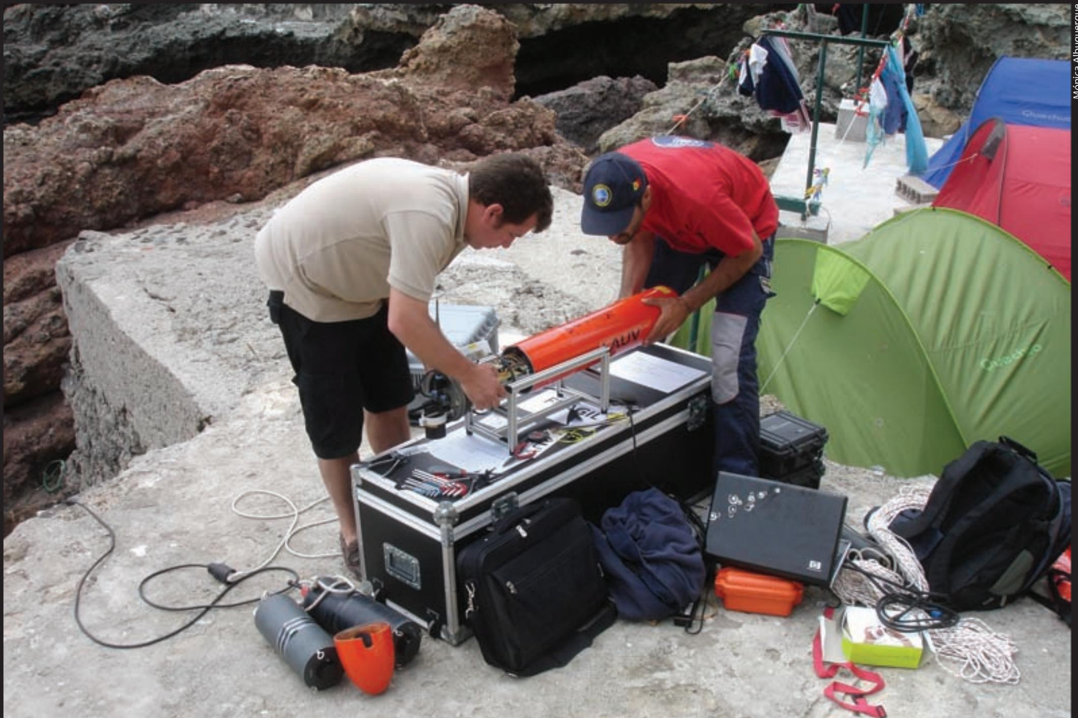
Preparação da operação com o Veículo Subaquático Autónomo (A.U.V.).
